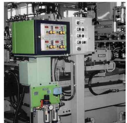
コントロールユニット取付例 Example attachment of control unit
